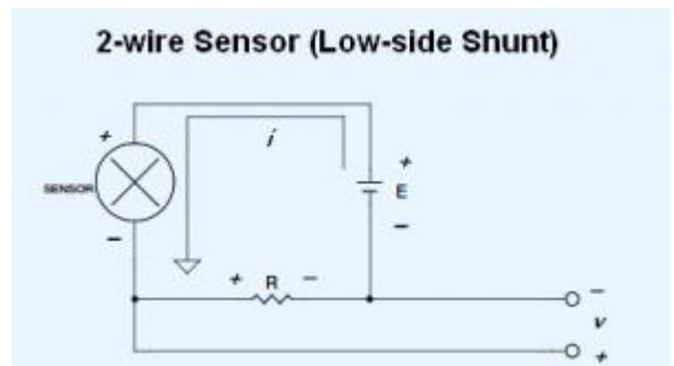
在大多数情况下，应注意将电阻器放置在环路的低端（如图所示），而不是高端。这样做的目的是可以允许使用非隔离的仪器进行测量。
